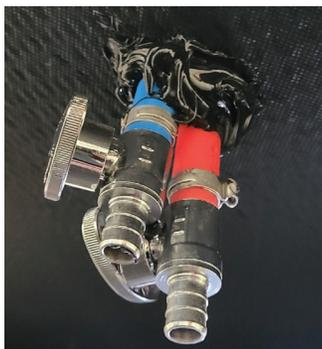
3. **BRANCHER** le tuyau fourni avec le dévidoir intégré ou un tuyau d'arrosage au port **EAU DE VILLE** du centre de commodité. Voir la photo à droite. Placer l'autre extrémité du tuyau d'arrosage dans le seau de 18,9 L qui contient votre solution assainissante.
