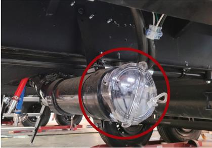
L'image ci-dessous montre le tube d'entreposage du tuyau d'égout. Le tube est capable d'entreposer deux sections de tuyau. Les extrémités de la vanne du tuyau doivent être retirées avant l'entreposage.
