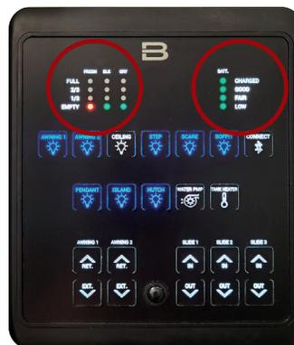
La partie encadrée rouge du panneau de surveillance, illustrée à droite, indique le niveau du réservoir d'entreposage. De plus, il affiche la tension de la batterie auxiliaire. Les renseignements sur la charge de la batterie sont indiqués sur la partie du panneau encadrée en bleu.
