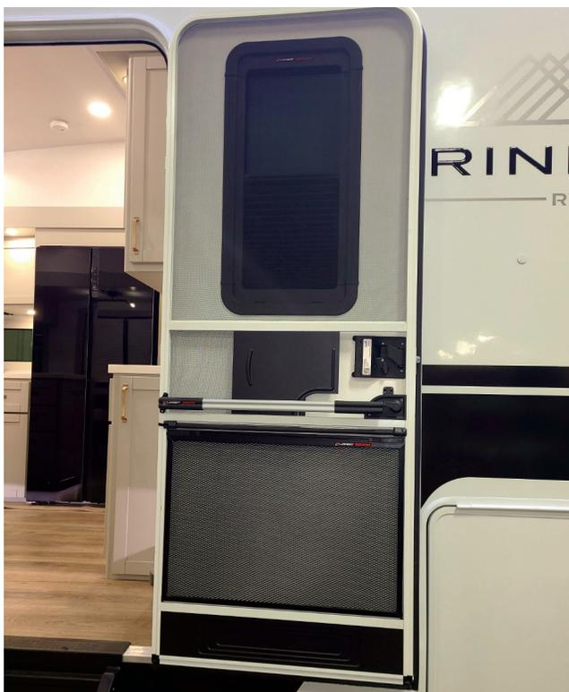
**2. Capture d'écran Lippert** — Le rectangle rouge du milieu met en évidence deux caractéristiques de la porte d'entrée. La première est la capture d'écran Lippert. Voici le tube noir qui est parallèle au sol sous le loquet de la porte. Il est doté d'une sangle à ressort qui ferme automatiquement la porte moustiquaire après son ouverture.
