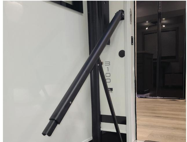
2. Il y a un canal intérieur et un canal extérieur qui comprend la main courante. Une fois la main courante déployée à l'étape (1), saisir fermement le canal intérieur situé au bas de la main courante et le tirer vers le bas et vers l'extérieur jusqu'à ce que le canal intérieur soit complètement déployé. Lorsque vous avez terminé, votre main courante devrait ressembler à la photo ci-dessous.
