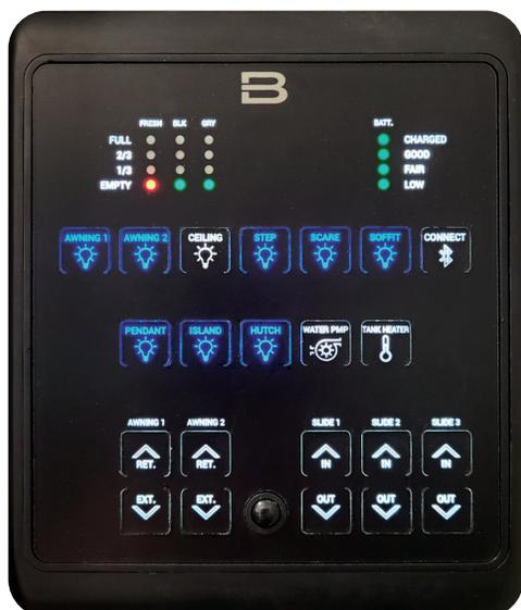
Les réservoirs de retenue font état de 4 niveaux standard : Pleins, 2/3, 1/3 et vides. L'état de la batterie s'affiche comme suit : chargée, bonne, moyenne et mauvaise. Parce que votre RV est équipé d'un moniteur de batterie, l'état correspond à un état de charge (SoC) spécifique :
