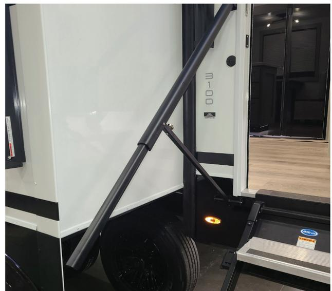
3. Inverser les étapes (2) et (1) ci-dessus pour entreposer la main courante pendant le voyage. Veiller à ce que la main courante soit bien positionnée de sorte que l'aimant s'engage sur la paroi latérale du RV.
