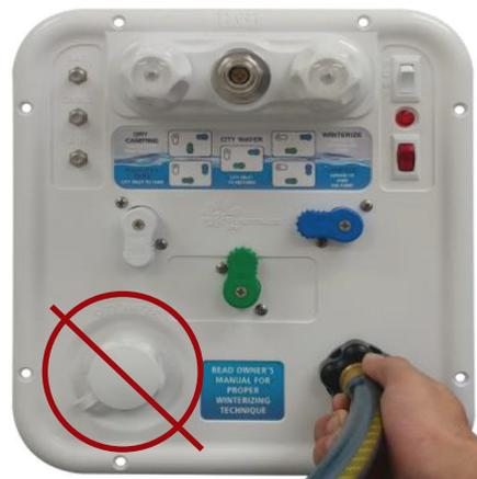
3. **RINCER** le ou les réservoirs de rétention noirs à l'aide de la conduite de rinçage du réservoir. Voir [la section 14L\(8\)](#) pour obtenir des instructions sur la façon de rincer le(s) réservoir(s) noir(s).
