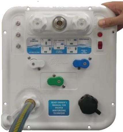
20. **BRANCHER** le tuyau fourni avec l'enrouleur de tuyau rétractable (voir [la section 14L\(8\)](#)) ou une courte section de tuyau d'arrosage à l'entrée étiquetée « **EAU DE VILLE** » sur le panneau de commodité central et comme indiqué sur l'image ci-dessus.
