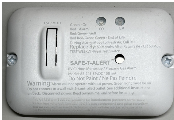
ALARME DE CO ET DE PROPANE.
