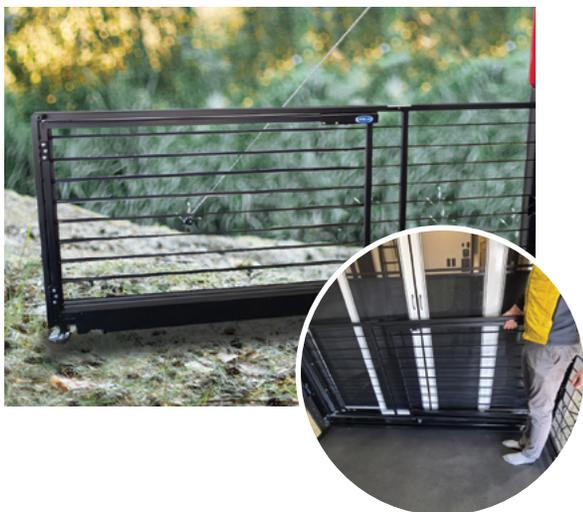
9. Repérez le loquet de pied suivant sur le garde-corps latéral de la porte (passager), et appuyez sur le loquet pour le dégager tout en tirant le garde-corps directement vers le VC jusqu'à ce que vous entendiez la goupille de retenue s'enclencher.
