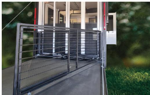
5. Lorsque le rail touche le bord de la porte rampe, vous devez sortir la partie télescopique du kit de rails jusqu'au coin le plus à l'extérieur de la porte rampe. Pour ce faire, il suffit de saisir le garde-corps en le guidant dans le sens des escaliers.
