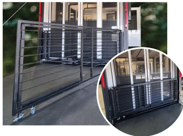
11. Avant de fermer la porte rampe, utilisez la bande Velcro pour attacher ensemble les deux garde-corps.
