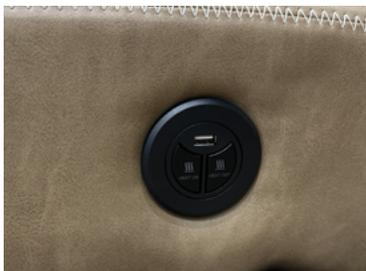
Votre CC peut être équipé de fauteuils inclinables chauffants. Pour les faire fonctionner, appuyez sur le bouton « Chauffage allumé ». Pour éteindre, appuyez sur le bouton « Chauffage éteint ». Ces canapés seront également équipés d'une prise USB se trouvant au-dessus des boutons.
