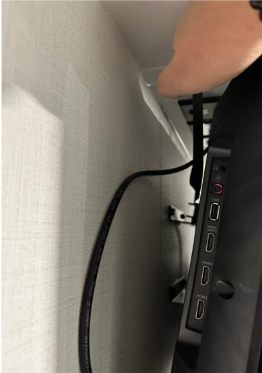
Tirez sur la sangle en nylon attachée au loquet de la patte du téléviseur. Faites ensuite glisser le téléviseur vers la droite jusqu'à ce qu'il sorte complètement de la patte.
