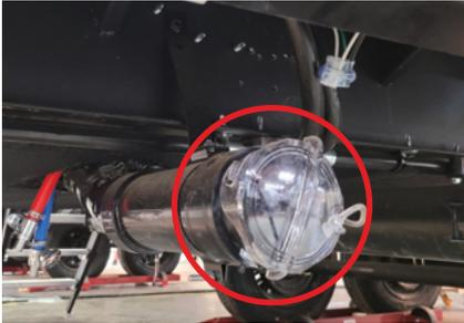
L'image ci-dessous montre le tube de stockage du tuyau d'eaux usées. Le tube peut stocker deux tronçons de tuyau. Les extrémités « robinet » du tuyau doivent être retirées avant rangement.
