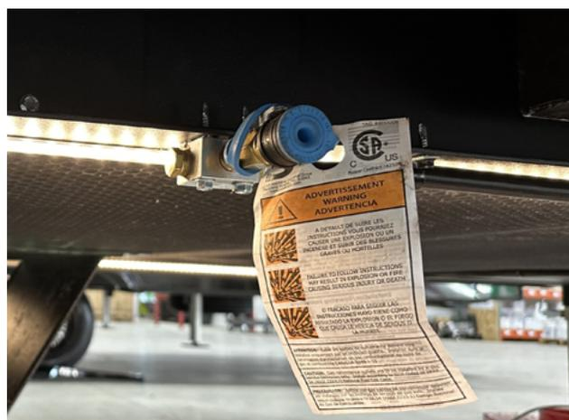
Votre appareil peut être équipé d'un raccord GPL à raccordement rapide se trouvant à l'extérieur de l'appareil. Il doit être utilisé pour les appareils au GPL tels que les grils, etc. Veuillez faire preuve de prudence lorsque vous utilisez un tel appareil lorsqu'il est raccordé au GPL.
