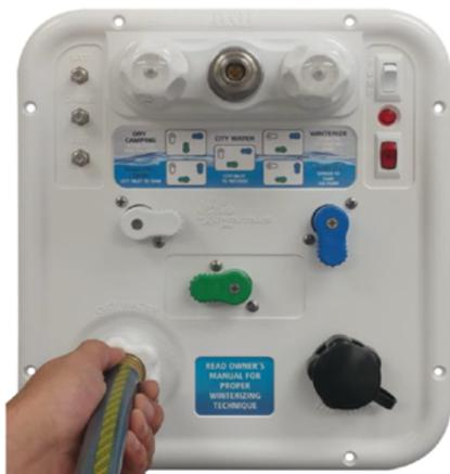
5. **ALLUMEZ** la pompe à eau et remplissez le réservoir d'eau douce et de toute la solution désinfectante. Vous pouvez allumer la pompe à eau sur le système de récupération des excréments (image en bas à gauche) ou sur le pupitre de contrôle (image en bas à droite) :
