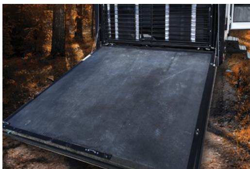
4. Pour fermer la porte rampe, assurez-vous que la porte d'entrée du « garage » soit ouverte. Cela permettra à l'air de s'échapper du garage lorsque la porte rampe se fermera.
