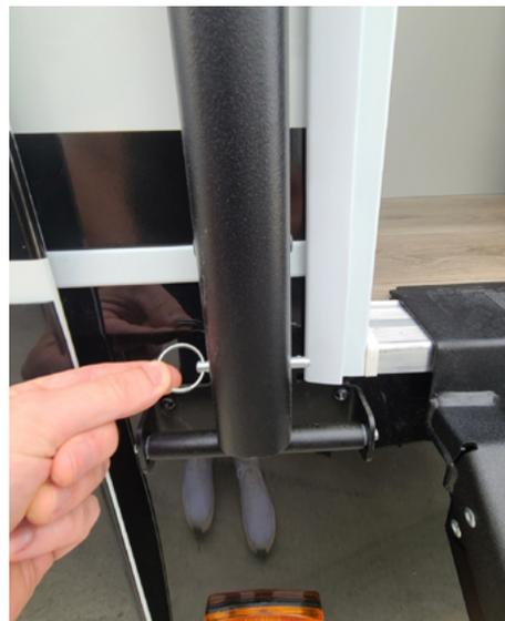
2. La main courante se compose d'un rail intérieur et d'un rail extérieur. Une fois la main courante sortie et allongée à l'étape (1), saisissez fermement le rail intérieur situé en bas de la main courante et tirez-le vers le bas et vers l'extérieur, jusqu'à ce qu'il soit complètement sorti.
