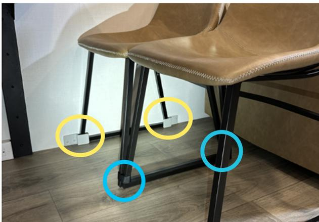
Pour fixer les chaises du coin repas pendant le roulement, faites glisser le cadre de chaise le plus proche de la paroi de la pièce escamotable, dans les pattes métalliques de chaise fixés (entourées en jaune). Utilisez les Velcro inclus (2, entourés en bleu) pour fixer la deuxième chaise à la chaise qui a été fixée au cadre métallique.
