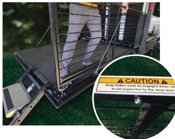
10. Faites pivoter le garde-corps latéral de la porte vers le VC jusqu'à ce qu'il touche l'autre garde-corps. Une fois le garde-corps côté porte (conducteur) proche de l'autre, il vous faudra soulever légèrement le garde-corps pour le fermer.
