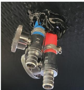
3. **RACCORDEZ** un tuyau d'arrosage à l'arrivée d'**EAU DE LA COMMUNE** sur le système de récupération des excréments. Voir image de droite. Mettez l'autre extrémité du tuyau d'arrosage dans le seau de 5 gallons (18,927 litres) qui contient la solution désinfectante.
