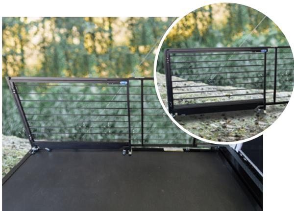
8. Le garde-corps latéral hors porte contient également la partie du garde-corps pour l'avant ou le haut de la porte rampe. Faites pivoter le garde-corps avant pour le mettre en place, et engagez le loquet comme indiqué sur la photo ci-dessous.
