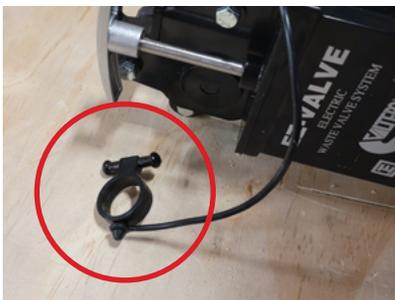
**Pour réenclencher les soupapes électriques, poussez la poignée à fond pour fermer la soupape, faites pivoter la poignée Valterra de 90 degrés dans le sens opposé pour la remettre sur sa position d'origine, puis remettez l'anneau en plastique noir sur la soupape.**
