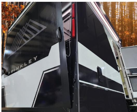
2. Après avoir posé une main sur la porte rampe pour la tenir, enflez la clé et tournez-la dans le sens inverse des aiguilles d'une montre pour ouvrir la porte rampe.
