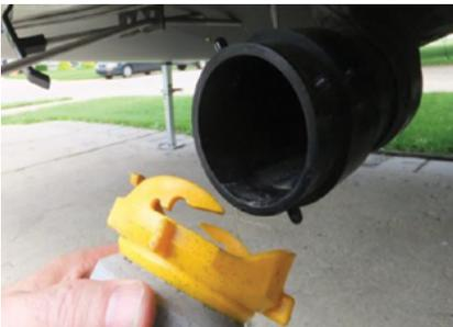
2. Ouvrez le réservoir à eaux usées sanitaires et laissez-le ouvert pour permettre au réservoir de se vider.
