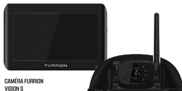
La caméra Furrion Vision S permet de regarder en fonction d'un angle de vision de 65 à 20 degrés, même la nuit, de détecter le mouvement et est équipée d'une fonction de réveil automatique pour un surcroît de sécurité lorsque le VC est à l'arrêt. Plus important encore, elle est installée pour vous aider à protéger votre VC.
