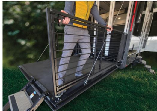
6. Une fois le garde-corps complètement sorti, engagez le mécanisme de fermeture à l'extrémité du garde-corps, comme l'indique l'image ci-dessous.
